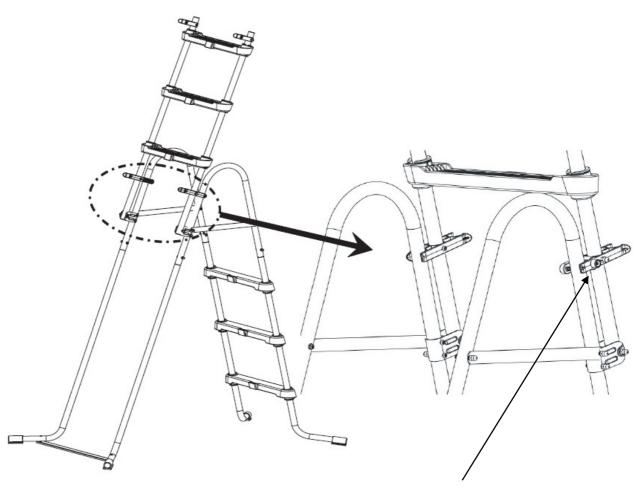
La Abrazadera giratoria con Control de la escalera la sujetará automáticamente en posición recta si queda suelta. Oprima el botón para desbloquear la escalera.
